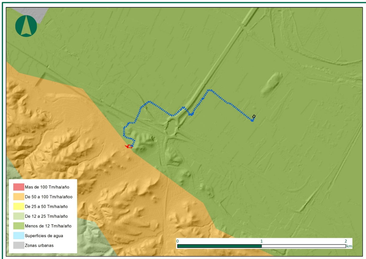
Figura 7. Tasas de erosión en la zona de estudio. Fuente: MITECO
